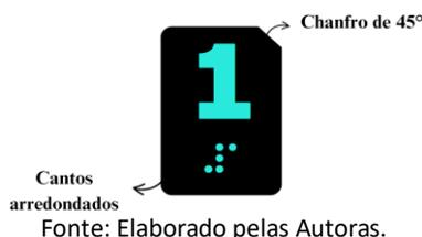
Já a base teve o arredondamento dos cantos e uma área vazada para acomodar as peças individuais. As hastes, onde são inseridas as peças, tiveram seu formato alterado, pois ao invés de serem arredondadas, passaram a ser retas, objetivando garantir mais estabilidade às peças, deixando-as alinhadas.
