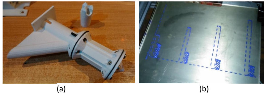
Figura 8: (a) Bomba helicoidal com rotor e estator de 3 estágios; (b) Resultados utilizando a bomba helicoidal 2 e após alterações nos parâmetros de entrada
