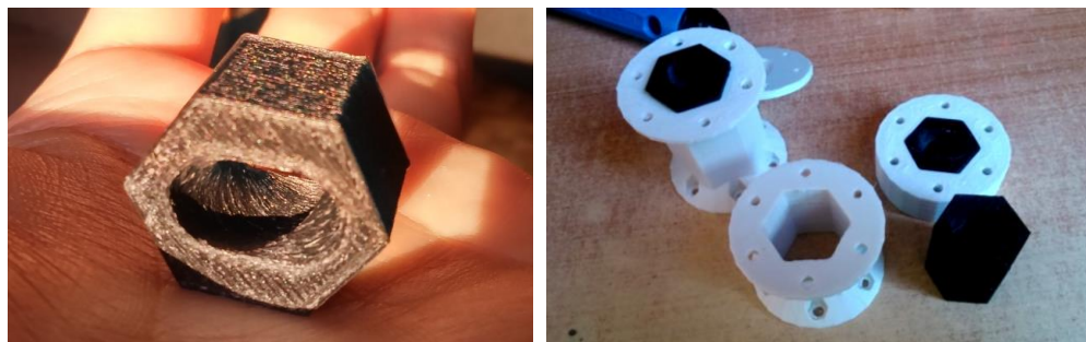
Figura 7: (a) Estator de 1 estágio, impresso em TPU; (b) Estatores e suportes
