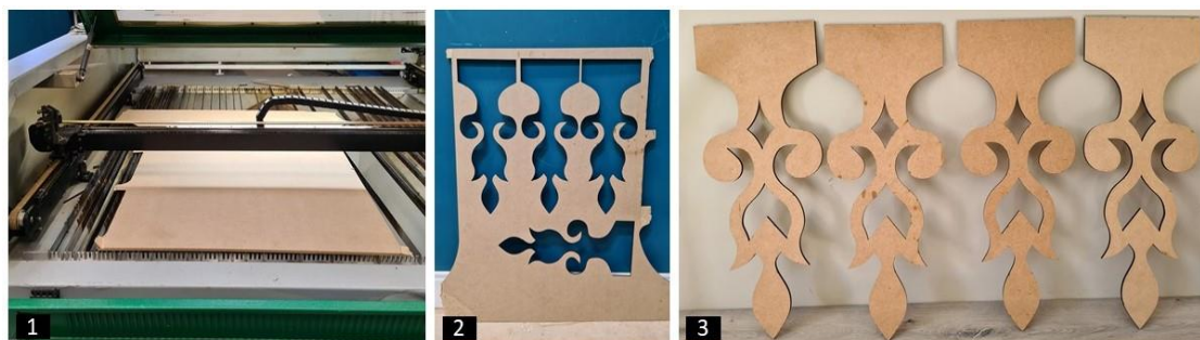
Figura 11: 1) Chapa de MDF posicionada para corte na DS4 Laser & Router; 2) Chapa de MDF após o corte das peças. 3) Peças de lambrequins cortadas e prontas para colagem.
