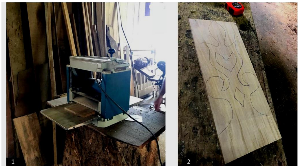
Figura 8: 1) Processo de plainar a madeira. 2) Desenho do molde do lambrequim na madeira já plainada.
