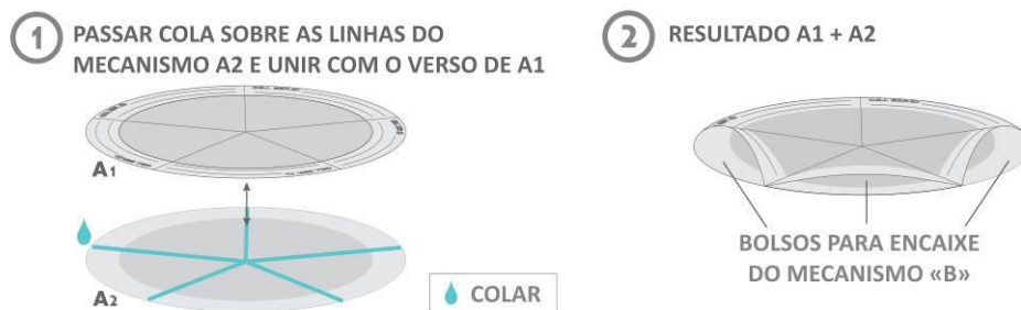
Figura 4: Montagem da ferramenta (fases 1 e 2)
