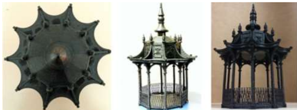
Figura 10: Torreão do reservatório produzido por impressão 3D
