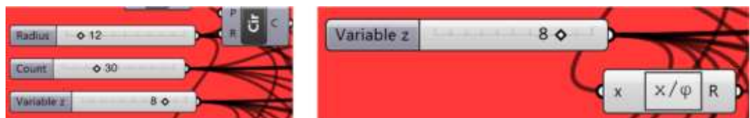
Figura 14: À esquerda: sliders para os valores de raio, número de colunas e altura das colunas; à direita: Operação algébrica para associar a altura da coluna à proporção áurea ( \phi (phi))
