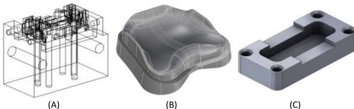
Figura 4: Exemplos de modelos virtuais wireframe (A), de superfície (B) e sólido (C)
