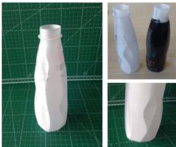
Figura 9: Imagens do modelo físico fabricado por impressão 3D
