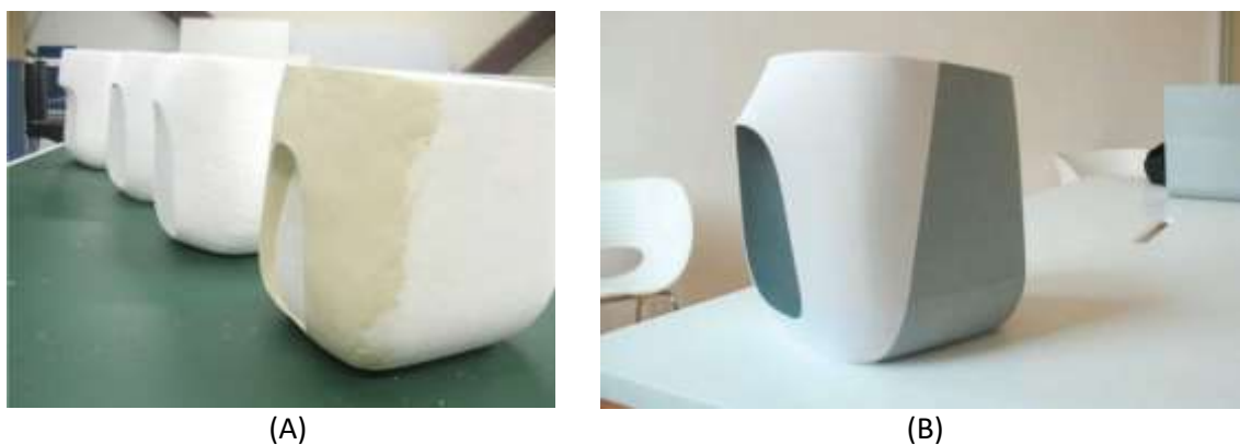
Figura 5: Modelos esculpidos manualmente (A) e modelo produzido em máquina CNC (B).
