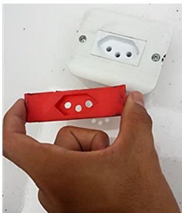
Figura 5: Modelo impresso 3D (peça na cor vermelha) do projeto de produto: Protetor de tomadas.
