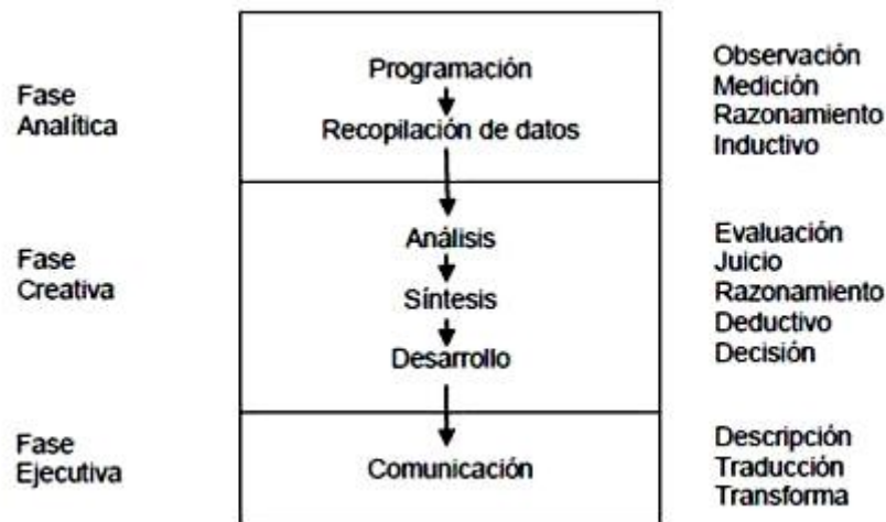
Figura 1: Representação esquemática do modelo metodológico de ARCHER (1963)
