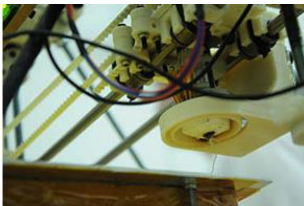
Figura 9: Bico Injetor de ABS Fundido e (à Direita)
