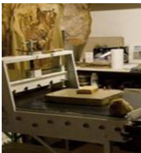
Figura 1: Ateliê em Preparo para Impressão: Pedra Calcária Sobre Prensa Litográfica, Esponja Natural, Água.
