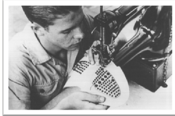
Figura 1: Pespontador costurando solado drive de mocassim na indústria Samello S.A.– Franca-SP, década de 1960.
