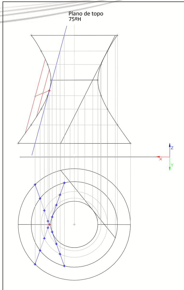
Figura 16: Representação da interseção do plano de topo com o hiperboloide (superfície de revolução).
