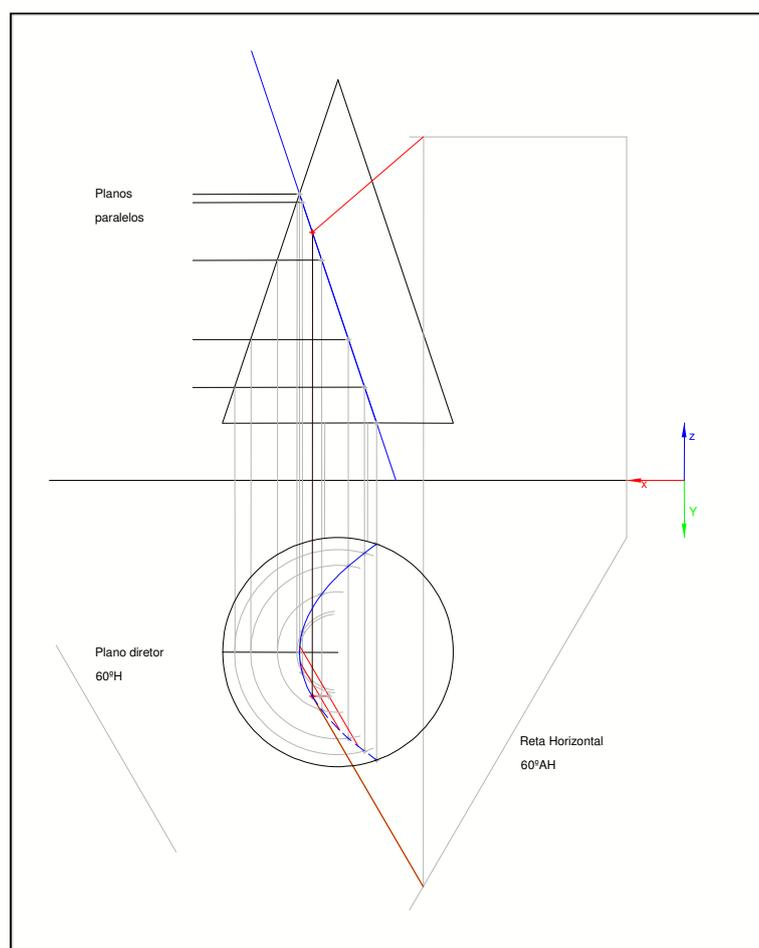
Figura 12: Determinação da reta tangente à parábola que define o limite de visibilidade na projeção horizontal
