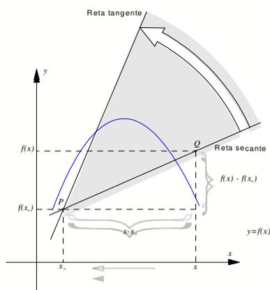
Figura 6: Quando a inclinação da reta secante tender ao limite, tem-se a inclinação da reta tangente
