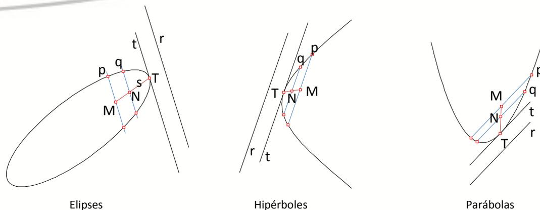
Figura 4: Aplicação das cordas paralelas no problema de tangência em curvas cônicas.
