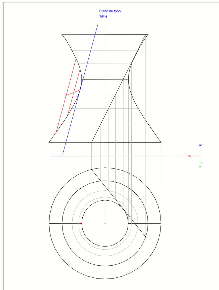
Figura 15: Determinação do ponto de tangência na hipérbole
