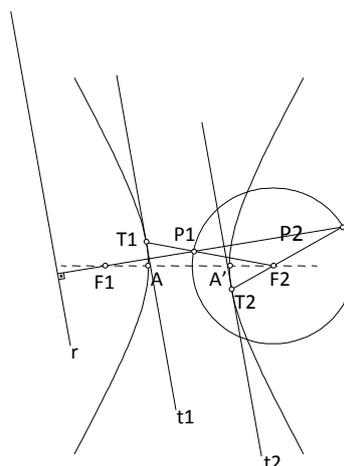
Figura 3: Determinação dos pontos de tangência na hipérbole, dada a direção da reta (r).
