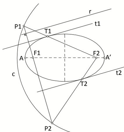
Figura 1: Determinação dos pontos de tangência na elipse, dada a direção da reta ( $r$ ).
