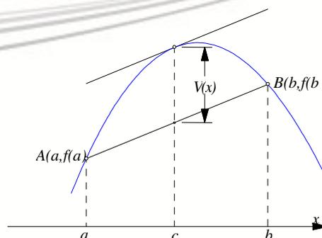
Figura 8: O ponto de tangência está na distância máxima entre a reta secante e a curva
