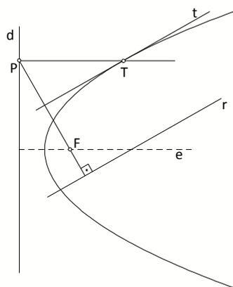
Figura 2: Determinação dos pontos de tangência na parábola, dada a direção da reta (r).
