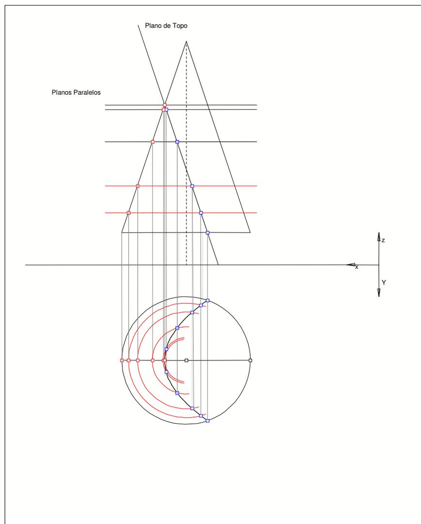
Figura 11: Determinação de uma das diretrizes do conoide (parábola)
