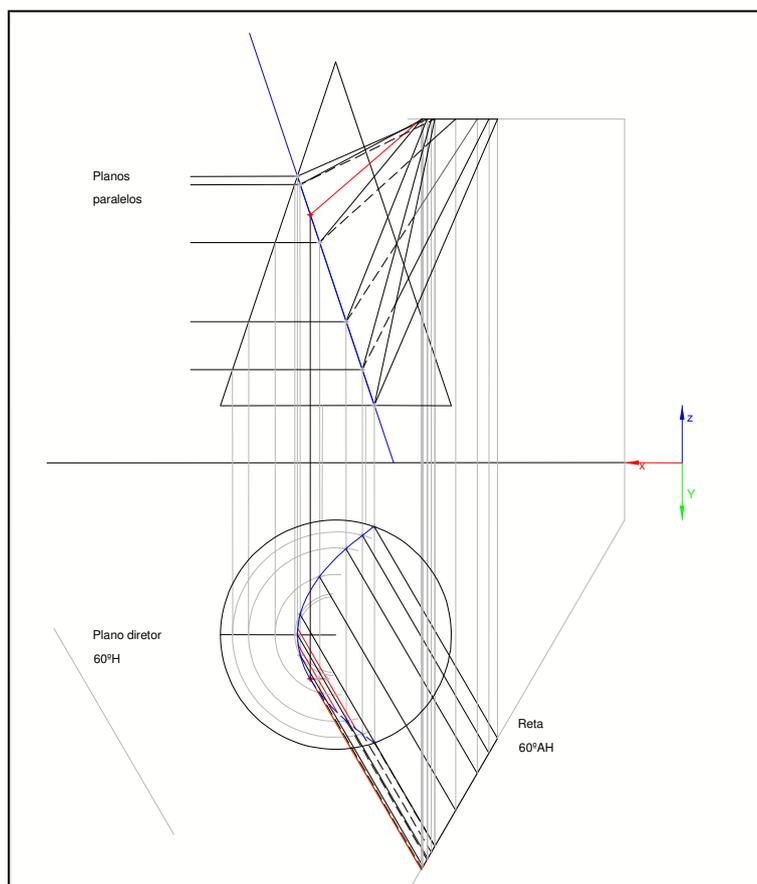
Figura 13: Representação do conoide (superfície reversa).
