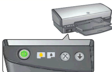
Figura 22: Pictograma aceso, indicando a falta de tinta e, conseqüentemente, a mudança de cartucho.
