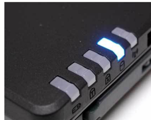
Figura 20: Dispositivos que indicam os status de algumas partes\funções em um notebook.
