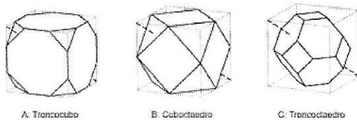
Figura 10: Poliedros semi-regulares gerados pelo seccionamento do cubo
