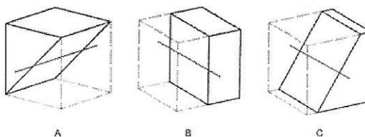
Figura 6: Plano secante contendo o eixo quaternário do cubo
