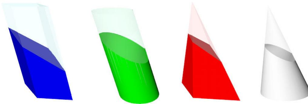
Figura 2: Tronco de prisma, de cilindro, de pirâmide e de cone.
