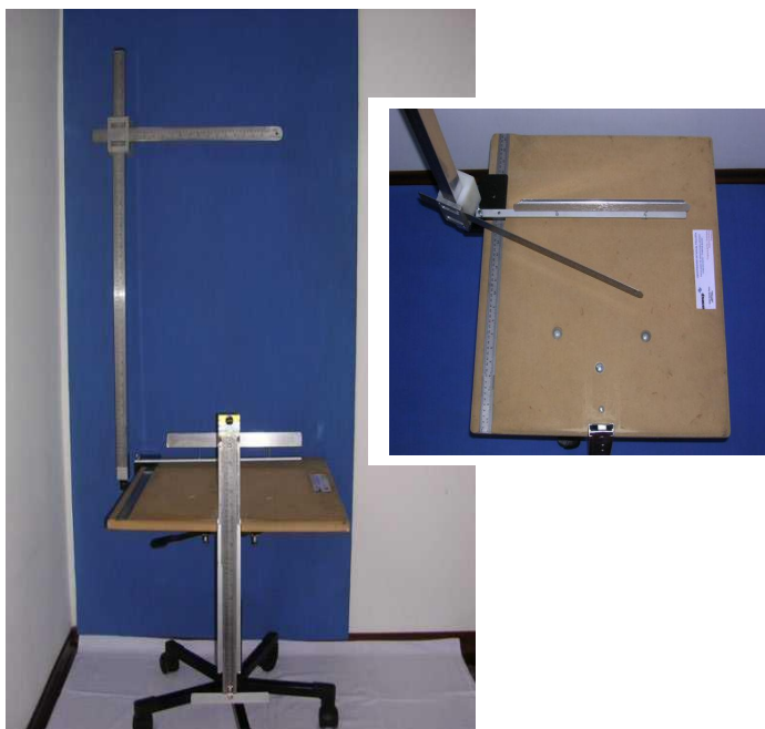
Figuras 1 e 2. Cadeira Antropométrica, vista de frente e Vista superior.
