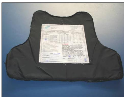
Figura 7: Capa interna do painel balístico, com a etiqueta de informações técnicas.
