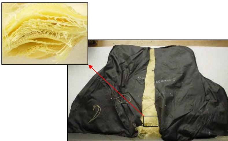
Figura 5 e Figura 6: Detalhes do tecido balístico em camadas sobrepostas, formando o painel.
