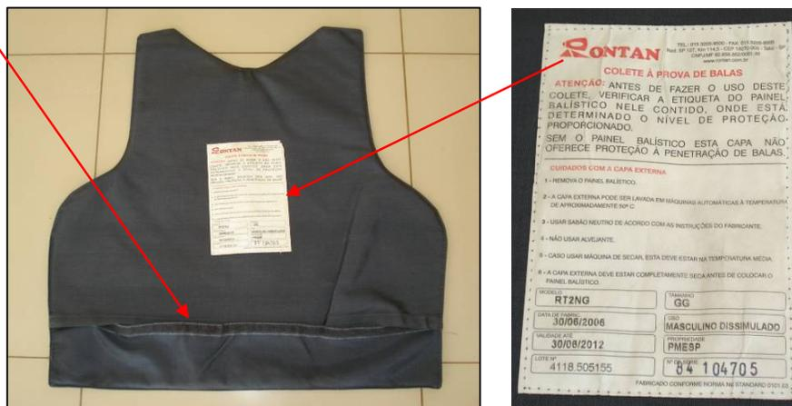
Figura 10 e Figura 11: Capa externa do painel balístico frontal e detalhe da etiqueta.
