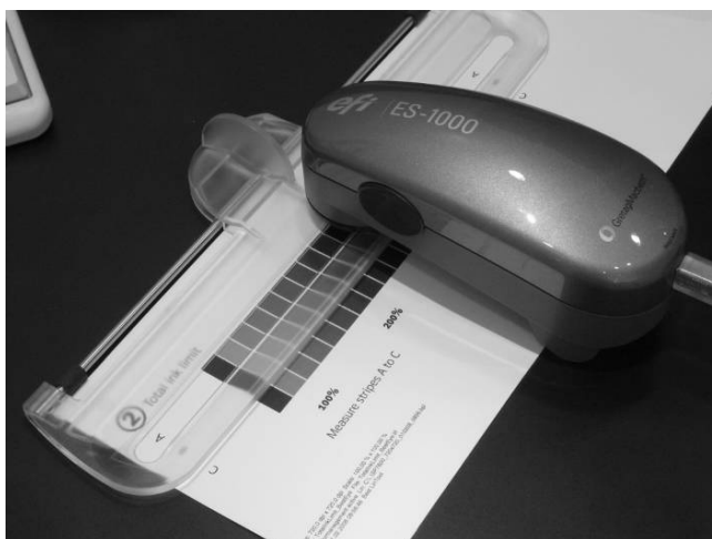
Figura 3: Cartela para determinação do limite total de cobertura das tintas.
